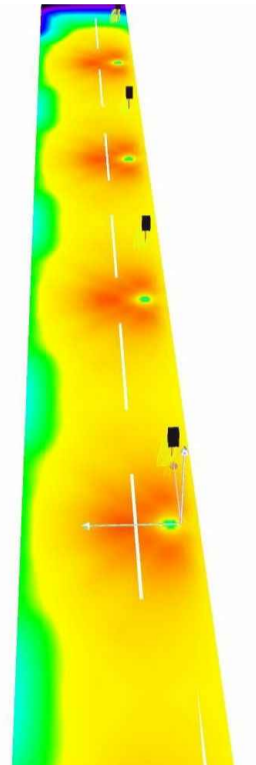
verifica illuminotecnica via Mazzini
