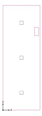
Superficie utile (Sgombero): Illuminamento perpendicolare (adattivo) (Superficie) Scena luce: Scena luce 1 Medio: 79.1 |x (Nominale:  $\geq$  500 |x), Min: 34.4 |x, Max: 91.6 |x, Min/Medio: 0.43, Min/Max: 0.38 Altezza: 0.800 m, Zona margine: 0.000 m
